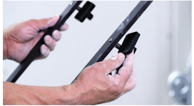
Gehäusefüße nach innen drehen.
