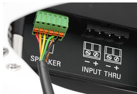
6-poliger Anschluss mit Systemklemmen
